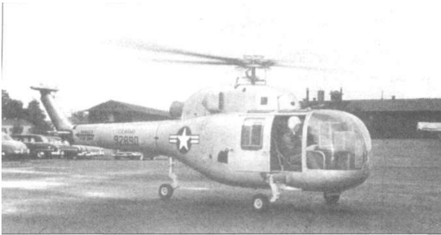
S-59 (XH-39) конверсионный вариант S-52-3 с газотурбинным двигателем. 1950 г.
